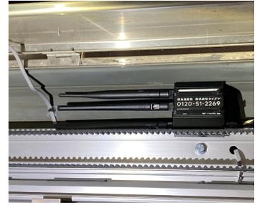
エンジンケースの状況により、機器の落下を防ぐため、アルミレール(2枚目の写真箇所)にビス留めをし固定させていただきます場合がございます。
